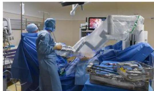
Les instruments opératoires sont fixés au bout de quatre bras articulés et grâce à une caméra, le chirurgien derrière sa console, pilote à distance avec une vision en trois dimensions
